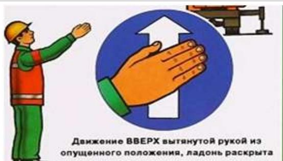
Определите действие крановщика по сигналам стропальщика?
