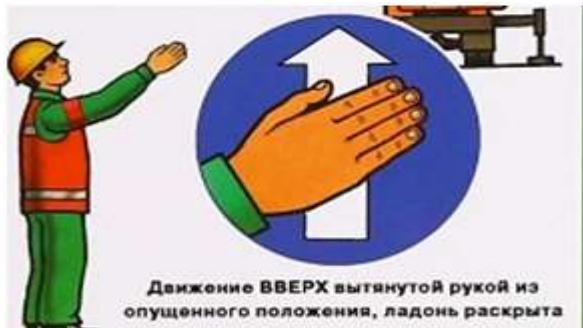
Определите действие крановщика по сигналам стропальщика?
