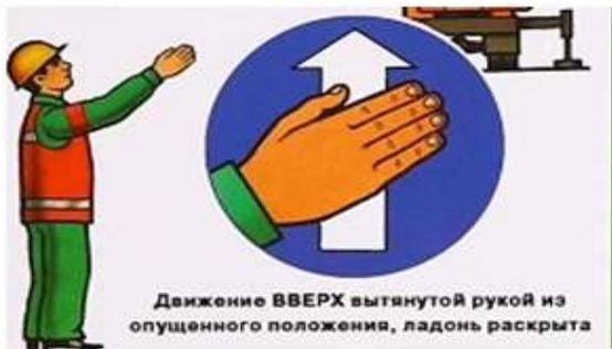
Определите действие крановщика по сигналам стропальщика?
